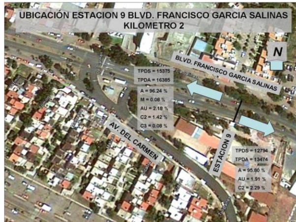
Figura 60. TPDS y clasificación vehicular en Estación 9
