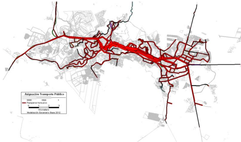
Figura 119. Asignación del transporte público. Escenario calibrado del periodo de máxima demanda de la mañana.
